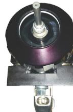
Encaja la boquilla de pulverización sobre la junta.
