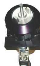
Enrosca el tapón sobre la boquilla de pulverización.
