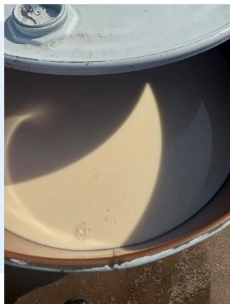
1. Mezcle durante 15 a 20 minutos a  $\geq 450$  RPM. Consulte la sección de mezclado para conocer el mezclador aprobado.
