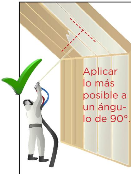
**APLICAR** de manera perpendicular con respecto a la cubierta, desde la parte inferior a la parte superior.
