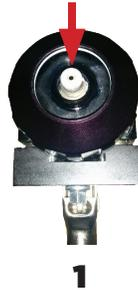
Insertar el sello en la punta de la cámara de mezcla.
